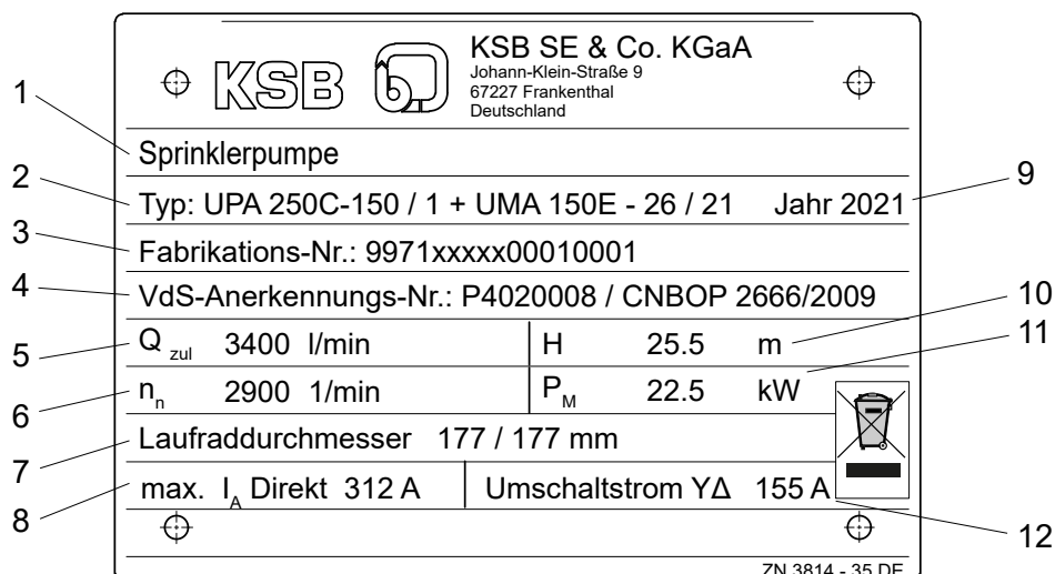
III. 4: Plaque signalétique d'un groupe motopompe pour installations sprinkler (exemple)
