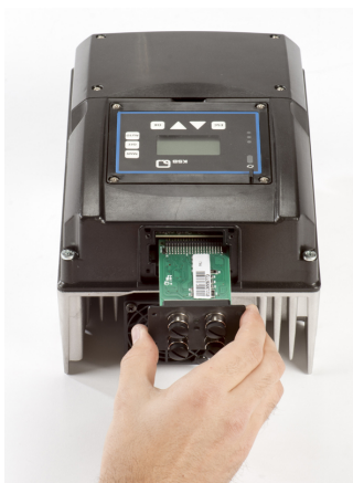
III. 29: Introduire le module M12
