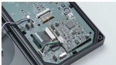
III. 50: Fixer le module Bluetooth
