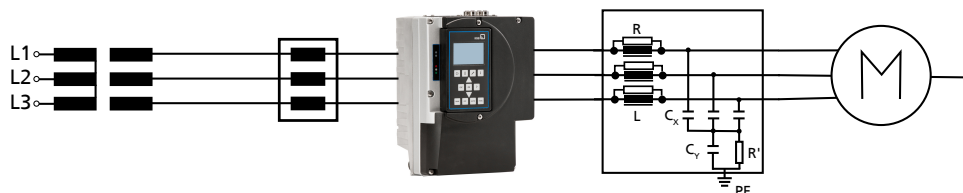
III. 31: Montage du self de réseau et du filtre de sortie
