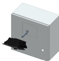
III. 3: Montage du coffret de commande dans l'armoire de commande
