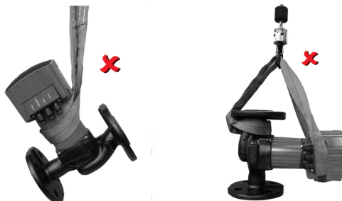
III. 2: Transport non conforme de la pompe
