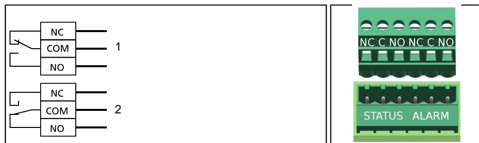
III. 12: Schéma de connexion report centralisé de défaut
