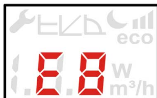
III. 16: Affichage du code d'erreur E8 (défaut moteur)
