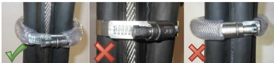
III. 18: Conseil d'installation des colliers de serrage
