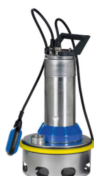
AmaDrainer 4, passage libre 35 mm, sans enveloppe de refroidissement, avec interrupteur à flotteur
